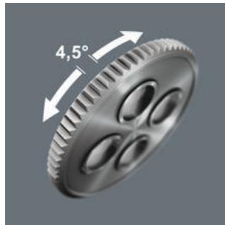
Gracias a su dentado fino con 80 dientes, la carraca Zyklop VDE permite un ángulo de recuperación de tan solo 4,5°.
