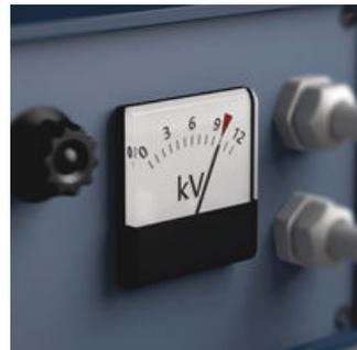
La prueba individual en un 100 % de las herramientas Zyklop para electricistas que se realiza a una tensión de 10.000 voltios según IEC 60900, garantiza un trabajo seguro bajo una tensión de hasta 1.000 voltios.
