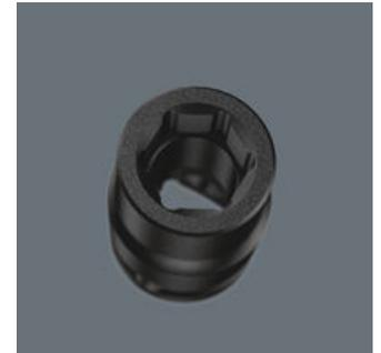
El perfil hexagonal permite la transmisión de altas fuerzas y significa menos carga para los bordes de la tuerca del tornillo, o de la cabeza del tornillo, en comparación con el perfil bihexagonal. Además, gracias al ángulo de retorno mínimo de las carracas de dentado fino, ya no hace falta utilizar el perfil bihexagonal en situaciones de montaje muy estrechas.
