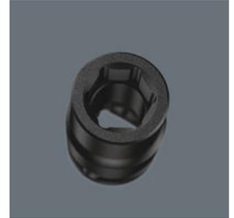
El perfil hexagonal permite la transmisión de altas fuerzas y significa menos carga para los bordes de la tuerca del tornillo, o de la cabeza del tornillo, en comparación con el perfil bihexagonal. Además, gracias al ángulo de retorno mínimo de las carracas de dentado fino, ya no hace falta utilizar el perfil bihexagonal en situaciones de montaje muy estrechas.
