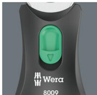
Con ayuda del conmutador corredizo que se encuentra montado a ambos lados, la cabeza de la carraca se puede fijar en las posiciones definidas a los 0°, 15° y 90° hacia la derecha y la izquierda.
