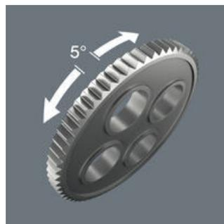
El dentado fino con sus 72 dientes permite un ángulo de retorno mínimo de tan solo 5° para realizar trabajos en situaciones de montaje de muy poco espacio.
