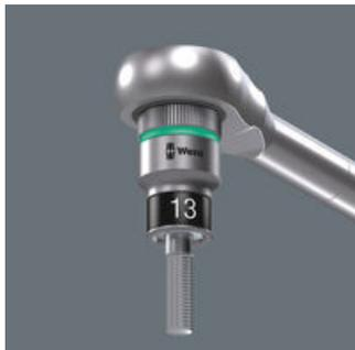
La sujeción del tornillo de hexágono exterior en la llave de vaso se realiza por medio de dos bolas de resorte y un tubo termoretráctil de elasticidad permanente y de alta resistencia. El tubo está protegido contra el desgaste y rasguños por un anillo de acero frontal. La función de retención es especialmente adecuada para situaciones de difícil acceso, en las cuales no es posible utilizar la mano para sostener el tornillo.
