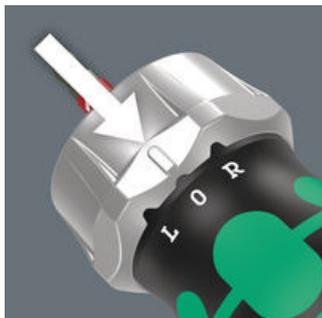
El mecanismo de carraca está finamente dentado para un ángulo de retorno bajo. La dirección de atornillado puede cambiarse a derecha/fija/izquierda mediante el anillo de cambio. El portapuntas magnético es adecuado para puntas de arrastre hexagonal exterior de 1/4" según DIN ISO 1173-C 6.3 y serie de conexión de Wera 1.
