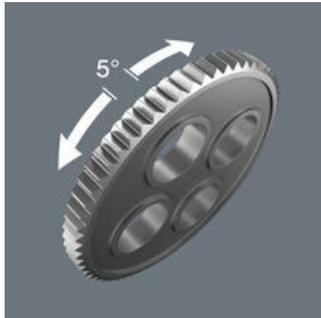
Las carracas reversibles de dentado fino con 72 dientes, disponen de un ángulo de recuperación mínimo de tan sólo 5°. Esta carrera mínima permite realizar un trabajo sumamente rápido y preciso en cualquier posición de montaje.
