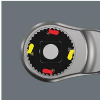
Gracias al doble mecanismo de trinquete, los 38 dientes robustos proporcionan el efecto de un dentado fino de 76 dientes con un ángulo de recuperación de 4,7°.
