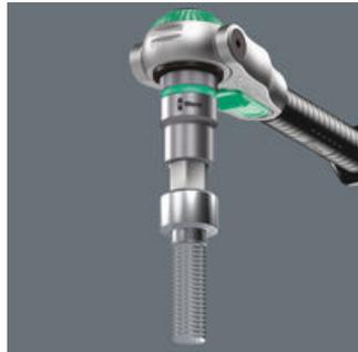
La sujeción del tornillo de hexágono interior en la llave de vaso se realiza por medio de una bola en la punta. Este útil es especialmente adecuado para situaciones de difícil acceso, en las cuales no es posible utilizar la mano para sostener el tornillo.
