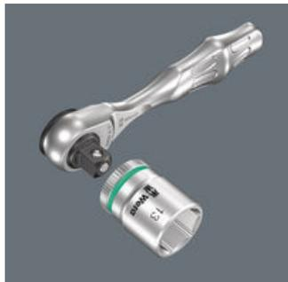
La carraca Zyklus Mini 3 de Wera es la herramienta ideal si se trata de trabajos en uniones atornilladas que se realicen en espacios estrechos. El dentado superfino con sus 60 dientes permite un ángulo de retorno mínimo de tan solo 6°; la rueda moleteada permite movimientos de giro muy rápidos al atornillar, especialmente cuando no se tiene suficiente espacio para los movimientos de volteo con la carraca completa.
