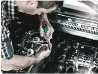
Carraca Zyklop Hybrid con un largo total elevado (efecto de palanca) y cabeza de carraca delgada
