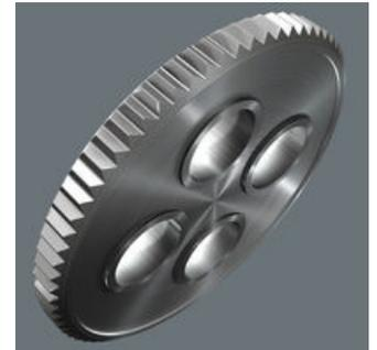
Las carracas reversibles de dentado fino con 72 dientes, disponen de un ángulo de recuperación mínimo de tan sólo 5°. Esta carrera mínima permite realizar un trabajo sumamente rápido y preciso en cualquier posición de montaje.
