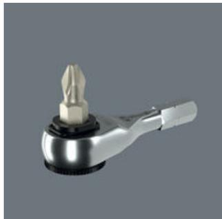
La carraca de puntas Zyklop Mini 4 es adecuada para la toma de puntas con arrastre hexagonal exterior de 1/4" según DIN ISO 1173-C 6,3 y E 6,3 así como las series de conexión de Wera 1 y 4
