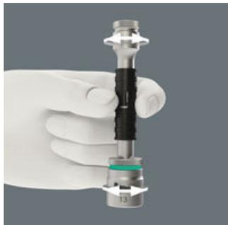
Las extensiones de la gama alta además están equipadas con el sistema de bloqueo flexible "Flexible-Lock". Si el sistema está activado, las herramientas necesarias para el trabajo se pueden colocar de manera permanente en la extensión. Así se evita una pérdida indeseada de la herramienta, o que el útil se salga por deslizamiento. Tan pronto el sistema está desactivado, los vasos se pueden encajar o desencajar como siempre, y es posible cambiarlos en un santiamén.
