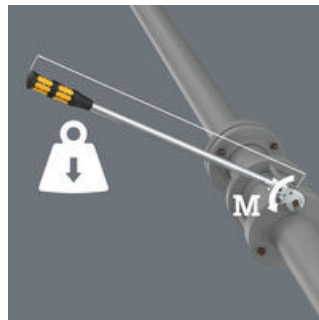
Con el útil de inserción montado, la herramienta operativa 9999 es adecuada para apretar y soltar uniones atornilladas fijamente atascadas - sin función de par de giro.
