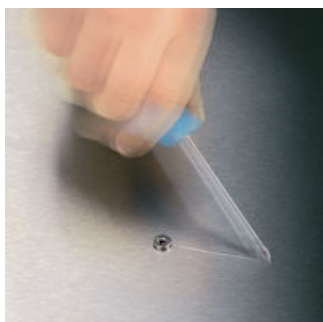
Det sker igen og igen, at man ved skruring smutter ud af kærven. Nogle gange beskadiges kostbare overflader derved eller man kommer selv galt afsted. Spidsen på Wera Lasertip-skrueværktøjsæt gøres mikroskopisk fint ru med laserstråler. Denne ru overflade "bider" sig ligefrem fast i kærven. Det utilsigtede smutten ud af kærven hører dermed fortiden til.
