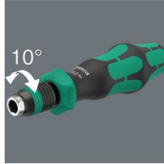
Die integrierte Ratsche mit Feinverzahnung (36 Zähne) und einem Rückholwinkel von 10° vereinfacht und beschleunigt das Schrauben ohne mühsames Neuansetzen. Mit ergonomischem Kraftform Griff und Schnellwechselfutter Rapidaptor.
