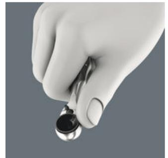
Bitratsche in gesenkgeschmiedeter Vollstahlausführung. Feinzahnmechanik mit 60 Zähnen ermöglicht einen kleinen Rückholwinkel von 6° für präzises Arbeiten. Einfachste Bedienung auch mit nur einer Hand in beengten Schraubanwendungen. Das Rändelrad erlaubt schnelles Schrauben in beengten Situationen. Für 1/4" Bits. Über Adaptierung mit Wera Verbindungsteil 870/1 ist auch der Einsatz von 1/4"- Nüssen möglich.
