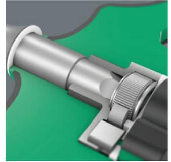
Die integrierte Ratsche mit Feinverzahnung (80 Zähne) und einem Rückholwinkel von 4,5° vereinfacht und beschleunigt das Schrauben ohne mühsames Neuansetzen. Mit Schnellwechselfutter Rapidaptor für 1/4" Bits.
