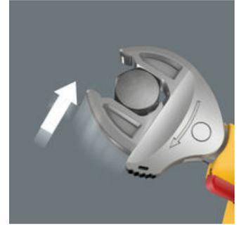
Durch die automatisch stufenlos zugreifenden parallel geführten Backen deckt der Joker Maulschlüssel 6004 VDE alle Abmessungen im jeweiligen Anwendungsbereich ab. Die benötigte Größe findet der Schlüssel beim Ansetzen an der Mutter oder Schraube ohne Einstellen von selbst.
