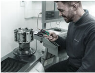
Drehmomentschraubendreher mit Schnelleinstellung
