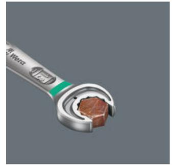
Die clevere Doppelsechskant-Geometrie des Jokers macht die Verbindung mit Schraube oder Mutter formschlüssig - das sitzt. Und die austauschbare, gehärtete Metallplatte im Maul des Jokers verbeißt sich mit extrem harten Spitzen in die Schraube. Beides verringert die Abrutschgefahr auch bei hohen Drehmomenten.
