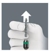
Zum Bitwechsel einfach die Hülse nach vorne schieben: Dabei hebt der Federmechanismus den Bit vom Magneten ab und entriegelt das Werkzeug. Der Bit kann problemlos entnommen werden. Besonders hilfreich: Mühelose Entnahme auch kleinster Bitgrößen ohne Hilfswerkzeug.
