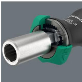
Die integrierte Ratsche mit Feinverzahnung sorgt für schnelles und sicheres Arbeiten. Die Knarrenmechanik ist vollständig im Griff eingebettet. Die kleine Größe des Griffs ermöglicht den Einsatz der Ratsche auch in beengten Schraubsituationen.
