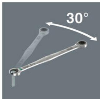
Durch die Doppelsechskant-Geometrie seines Maulendes wird der Rückholwinkel des Joker 6007 auf 30° reduziert. Der Joker 6007 hat ein gerades Maul, so dass er nicht mehr umständlich gewendet und neu angesetzt werden muss.
