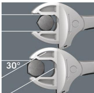
Über die Eckweitenprismen in beiden Mäulern des Doppelmaulschlüssels wird ein Rückschwenkwinkel von nur 30° ermöglicht.
