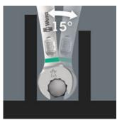
Der Ringmaulschlüssel Joker 6003 mit seiner besonderen Maulgeometrie - eine um 7,5° geschwenkte Maulseite und die Doppelsechskantgeometrie verdoppelt die Ansetzmöglichkeiten bei wiederholter 180°-Drehung des Schlüssels um die Längsachse. Muttern bzw. Schraubenköpfe 15° können alle "gepackt" werden. Den jeweiligen Ansetzpunkt findet der Joker 6003 nach jedem Wenden sozusagen von selbst.
