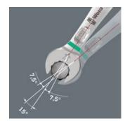
Durch die um 7,5° geschwenkte Maulseite, Doppelsechskantgeometrie eine angepasste Anwendungsweise (Ansetzen -Schrauben - Drehen - erneut Ansetzen - Schrauben - Drehen usw.) können auch Schraubsituationen gelöst werden, die weniger als 30° Schwenkwinkel zulassen.
