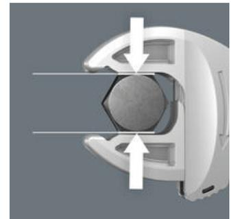
Die parallelen glatten Backen des 7870 Joker ermöglichen eine Flächenpressung und können dadurch das Verrunden der Mutter bzw. des Schraubenkopfes vermeiden, was bei der Kraftübertragung über Ecken auftreten kann.
