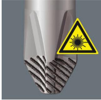
Mittels eng fokussiertem Laserlicht wird eine scharfkantige Oberflächenstruktur erzeugt. Wera Lasertip kratzt sich im Schraubenkopf fest und verhindert das Herausrutschen aus dem Schraubenkopf. Bei Schlitz, Phillips und Pozidriv.
