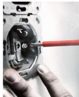
Unverzichtbar für den Einsatz bei Reihenklemmen, Sicherungskästen, Schaltern, Relais etc.: Die Profilkombination aus Schlitz und Phillips bzw. Schlitz und Pozidriv.
