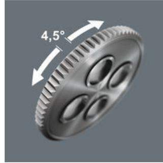
Die Zyklus Comfort Knarre ermöglicht durch ihre Feinverzahnung mit 80 Zähnen einen kurzen Rückholwinkel von nur 4,5°.
