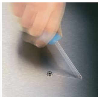
Stává se to stále znovu: při šroubování šroubovák vyklouzne ze šroubu. Někdy se poškodí cenné povrchy nebo se pracovník dokonce zraní. Hrot šroubováků Wera Lasertip je mikroskopicky lehce zdrsňený laserovými paprsky. Tento drsný povrch se "zakousne" do hlavy šroubu. Nežádoucí vyklouznutí šroubováku tak patří minulosti.
