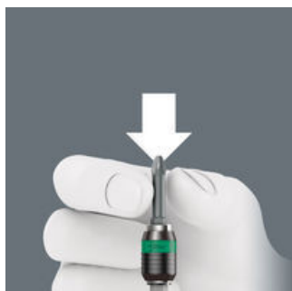
Bit lze zasadit do držáku bez manipulace s upínacím pouzdem. Jakmile je bit nasazen na šroub, samočinně se zajistí a sedí bezpečně, bez výkyvu.
