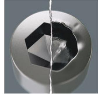
内六角螺丝存在一个问题，由于从扳头传递外力到螺丝的接触面很窄，导致螺丝头可能会损坏，通常是凹处被磨圆。Hex-Plus花形有较大的接触面，可防止这种损坏。它从凹槽的平面处驱动螺丝，而不是从角面，因此和一般L型扳手相比增加了20%可以被传递的扭矩。并且Hex-Plus工具适合每一个标准内六角螺丝。
