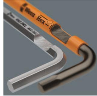
由圆形材料制成的L型扳手手感舒适，即使长时间使用也不费力。同时，橡胶护套提供了更好的握持感，尤其是在低温环境的情况下。颜色识别标识和印记方便找到需要的L型扳手。再者，圆形设计使工具更结实，尤其是尺寸较小的扳手。
