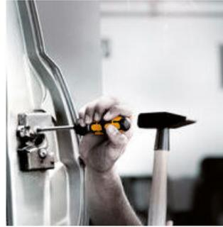
螺丝刀常被误用作凿子，这会非常危险。敲击螺丝刀不仅可用于拆装螺丝，还可适用于紧固、敲凿和松动卡死的螺丝。当工作变得棘手时，您需要维拉敲击螺丝刀！
