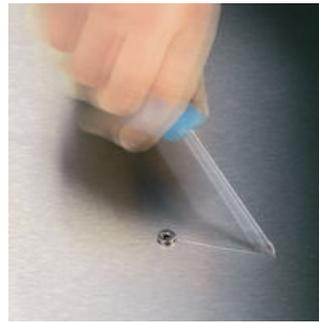
螺丝刀头用激光蚀刻出带有锋利边缘的沟槽，其硬度可高达 1000 HV 0.3。维拉 Lasertip 激光蚀刻刀头能抓紧螺丝头，有效防止打滑，可适用于一字、十字和梅花螺丝。
