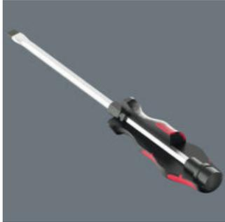
对于不仅需要旋拧的作业而言，凿子能提供解决方案。用于拧紧、敲凿并松动卡死的螺丝或软管夹。采用集成式冲击螺帽，以延长使用寿命，并降低碎裂风险。采用优质材料制成的磅推力六角刀杆，即使在锤击时也能实现无损高力度传输。坚固韧性强的回火材料防止刀杆分裂或破碎。将开口扳手或环形扳手连接到一体式六角垫板，可以传递更多扭矩。
