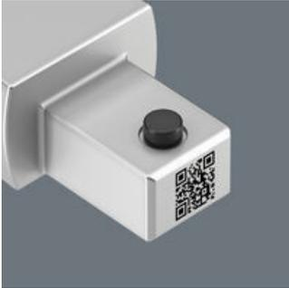
激光雕刻的耐磨二维码使得根据使用的扭矩扳手和嵌件工具确定正确的扭矩值变得更加容易。只需用智能手机或平板电脑扫描（如果有，两个二维码：扭矩扳手和嵌件工具）。网站会自动打开，识别扫描的工具（无需应用程序！）。然后输入所需的扭矩值；校正值是自动确定的。不需要使用公式/计算。
