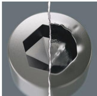
内六角螺丝存在一个问题，由于从扳手头传递外力到螺丝的接触面很窄，导致螺丝头可能会损坏，通常是凹处被磨圆。Hex-Plus花形有较大的接触面，可防止这种损坏。它从凹槽的平面处驱动螺丝，而不是从角面，因此和一般L型扳手相比增加了20%可以被传递的扭矩。并且Hex-Plus工具适合每一个标准内六角螺丝。
