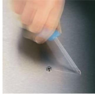
螺丝刀头用激光蚀刻出带有锋利边缘的沟槽, 其硬度可高达1000 HV 0.3。维拉Lasertip激光蚀刻刀头能抓紧螺丝头, 有效防止打滑, 适用于一字、十字和梅花螺丝。
