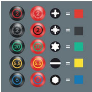
螺丝刀, 应用 Take it easy Tool Finder系统: 根据牙型进行颜色编码, 配合尺寸压印标记。
