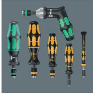
维拉扭矩螺丝刀。用户未指定扭矩值时原厂预设扭矩值为最小刻度值。针对在连续作业时所需要的定扭和精度。可以在原厂设定的测量范围内使用专用的工具重新定扭 (可购入商品编号为05137002001的校准用工具组)。然后, 您可以使用现成便携式扭矩检测器检查设定的扭矩值。在松开紧固的螺丝时扭矩并无特别限制。
