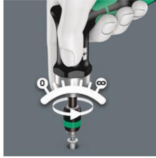
无限制制扭矩用于松动螺丝的方向。
