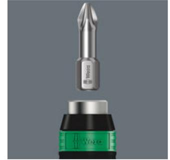
维拉扭矩螺丝刀。用户未指定扭矩值时原厂预设扭矩值为最小刻度值。针对在连续作业时所需要的定扭和精度。可以在原厂设定的测量范围内使用专用的工具重新定扭 (可购入商品编号为05137001001的校准用工具组)。然后, 您可以使用现成可携式扭矩检测器检查设定的扭矩值。在松开紧固的螺丝时扭矩并无特别限制。
