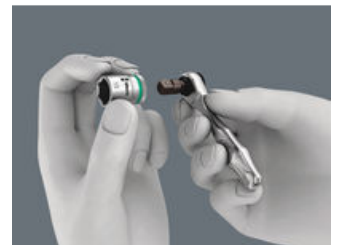
批头和套筒。批头可以直接连接到Zyklop Mini 1上, 也可以先连接一个快速套筒, 再连接批头, 这种方式也使其成为带自由旋转护套的延长杆。连接套筒需要1/4"六角驱动转接四角驱动的转接头, 例如维拉870/1转接头(也包括在Zyklop Mini 1套装里)。
