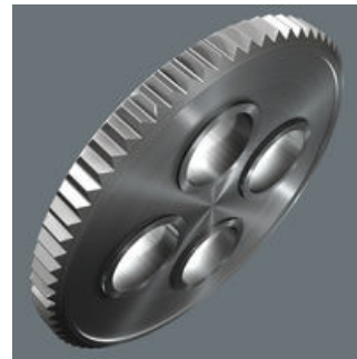
棘轮采用60齿细齿结构, 6°回转角是精密作业的理想选择。
