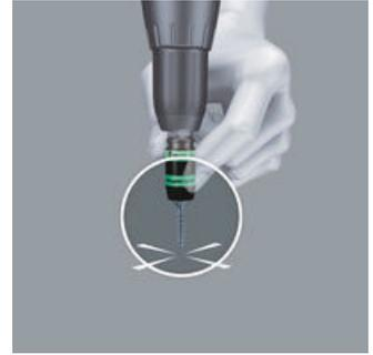
自由旋转护套保证在拆装工作时方便诱导工具和螺丝定位，使工具更易于在工件上进行紧固，防止发生滑脱。在使用1/4"批头作业时，它也可用作短延长杆，以结合维拉批头棘轮扳手或Zyklop系列使用。
