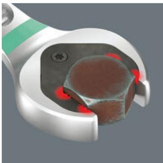
Joker巧妙地应用双六角几何形状, 为螺帽或螺栓提供了一个非常有效的连接。同时Joker口部带有加硬化处理过的可替换金属挡块, 其细微的硬齿可以牢牢咬住螺帽。这两个特点结合起来, 使其即使在较高的扭矩下, 也可以防止工具打滑。
