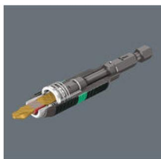
独特的双重抗扭设计集成了一个扭力区, 可吸收较极限的部分峰值载荷。接杆的抗扭结构会避免接头中的抗扭区出现任何过载的情况, 而剩余的峰值载荷则通过批头杆部第2段的扭转效应而大幅降。
