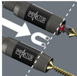
冲击接头配有环形磁铁，可绝对安全地固持住更长、更重的螺丝，使螺丝的定位更快速、更可靠。该接杆也是架空作业的理想之选。如果在某些特定情况下（如对金属作业时）想要避免使用磁铁功能，也可将其向后推出螺丝拆装作业区，实现功能禁用。该工具主要用于手持电动工具作业。
