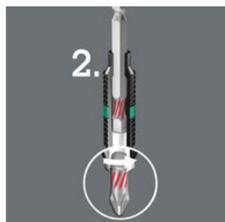
接头的支撑结构会避免夹具中的弹簧出现任何过载的情况，而更高的峰值载荷则通过批头杆部第2段的扭转效应而大幅降低。
