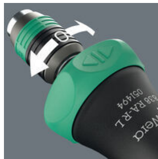
直观切换旋拧方向：顺时针旋转换向环切换到顺时针位置，反之亦然。
