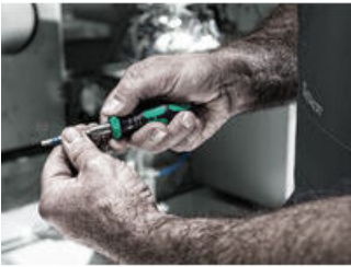
集成到手柄上的棘轮机构
