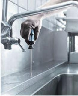
使用不锈钢工具拆装不锈钢螺丝
