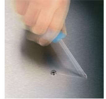
螺丝刀头用激光蚀刻出带有锋利边缘的沟槽, 其硬度可高达1000 HV 0.3。维拉Lasertip激光蚀刻刀头能抓紧螺丝头, 有效防止打滑, 可适用于一字、十字和梅花螺丝。
