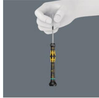
在拆装引擎及其相关工件时，不可能确保手拿着螺丝刀同时牢牢抓住螺丝，因此螺丝经常会掉下去，需要花大量时间去寻找，否则甚至可能引发危险。维拉开发的HF工具能够有效解决这一问题，它对原有的TORX® 梅花形状进行了优化，刀头和螺丝之间的表面压力形成了楔入力，从而使螺丝能牢固黏着在螺丝刀上。
