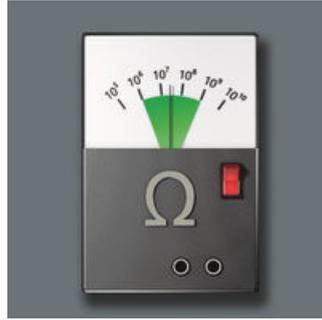
维拉ESD材料的表面电阻 $\leq 10^{10}$  ohm，能有效地保护组件，防止其产生静电并遭受相关的危害。
