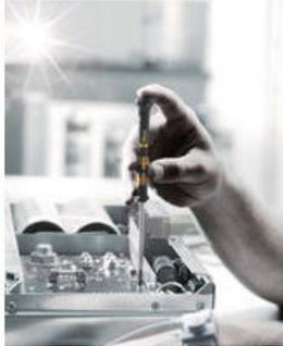
对手机或平板电脑等电子部件进行螺丝装卸作业时，静电电荷会造成故障或失灵。这使得防静电螺丝刀必不可少。
